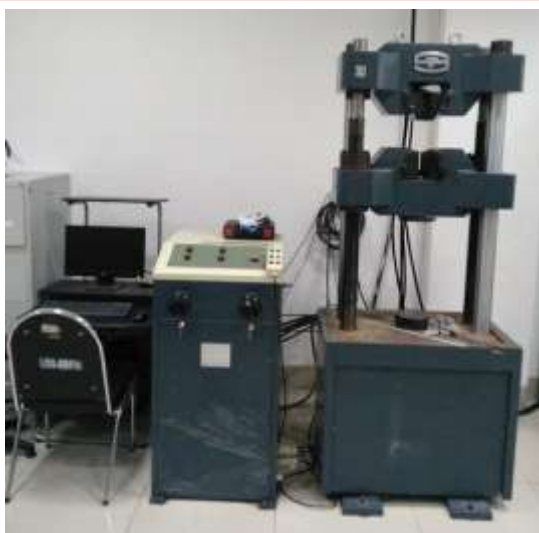
Gambar 1. Mesin uji UTM hidrolik 300 kN model WEW-300D
